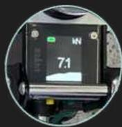
Pantalla a todo color lista para la luz solar, visible en todas las condiciones de iluminación, que muestra la carga en vivo y máxima simultáneamente.
