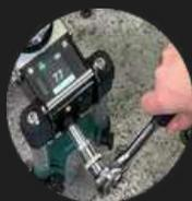
Realice pruebas con facilidad, con menos de 25 Nm de par se puede alcanzar 60 kN.
